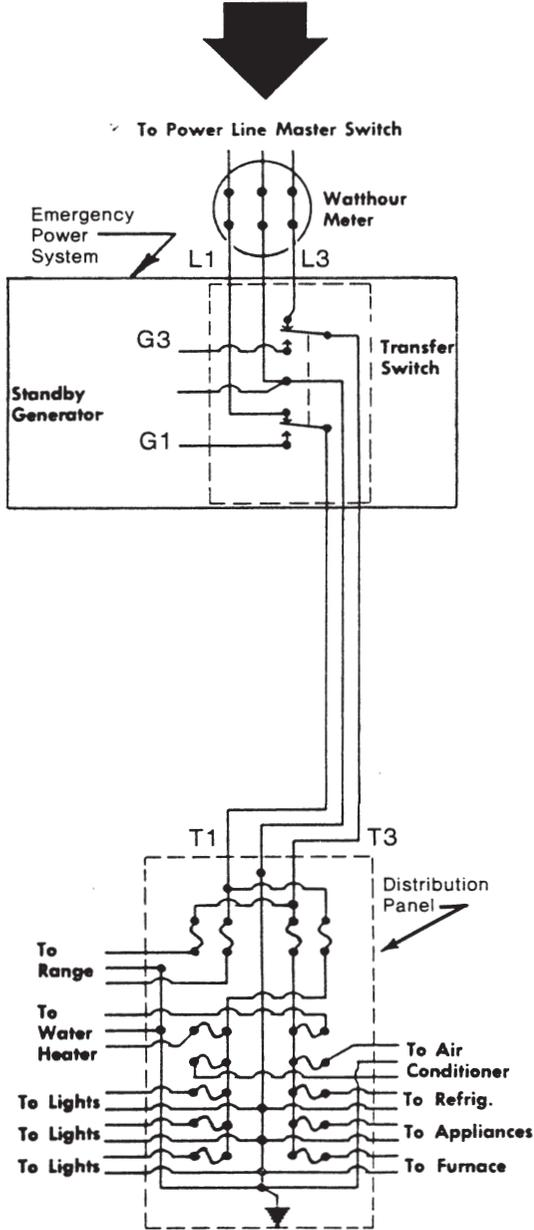
TYPICAL HOOK UP FOR SUPPLYING ONLY ESSENTIAL CIRCUITS WITH EMERGENCY POWER
