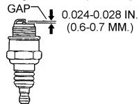
Figure 29. Spark Plug Gap
