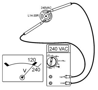
Figure 24. 120/240V Receptacle (240V)
